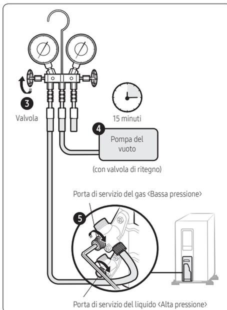
3 Aprire la valvola del lato di bassa pressione del manometro del collettore in senso antiorario.
