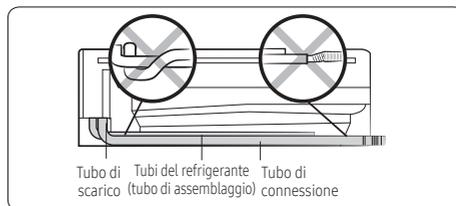
In Fase 2-2, durante la Fase 3 si è scelta la posizione di uscita per il gruppo delle condutture. L'unità è dotata di tre fori di uscita coperti a sinistra, a destra e in basso. Quando il gruppo deve uscire direttamente dal pannello posteriore, non si utilizza nessuno di questi fori di uscita.
