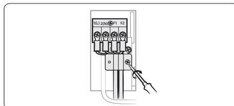
3 In Fase 2-2, durante la Fase 3 si è scelta la posizione di uscita per il gruppo delle condutture. Se si utilizza l'uscita a sinistra, a destra o in basso, stendere i cavi attraverso il foro prescelto.
