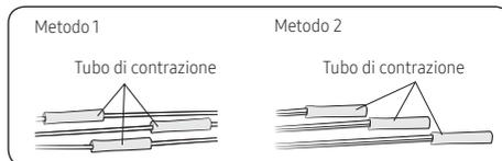
6 Ricoprite due o più volte con il nastro isolante e posizionate la guaina termorestringente al centro del nastro isolante.
